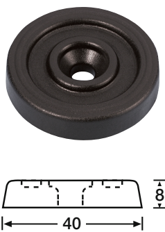
4921 40 MM PLASTIC FOOT Black, height 8 mm, weight 7 g. Fixing hole Ø 6.1 mm 40 MM PLASTIKFUSS Schwarz, Höhe 8 mm, Gewicht 7 g. Befestigungsloch Ø 6,1 mm
